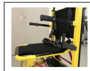
**7.0) Trasporto manuale.** In caso di improvvisa avaria della batteria, dovendo ancora trasportare il paziente, si dovrà effettuare il trasporto manualmente. Utilizzare necessariamente le maniglie telescopiche anteriori (10) allungandole totalmente e quelle posteriori (3)
