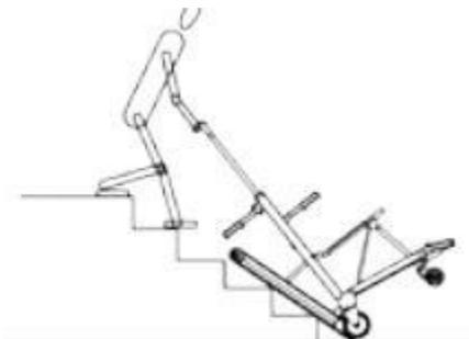
**IMPORTANTE :** *Per salire le scale, prima di azionare il movimento elettrico dei cingoli, portare questi ultimi perpendicolari alle scale e fare in modo che entrambi facciano presa sui gradini.*
