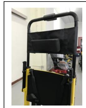
**13.0).Apertura Cingoli. (5)** Per salire/discendere le scale dobbiamo portare in posizione di "lavoro" i due cingoli posti nella zona posteriore della sedia, richiudendo preventivamente le 2 impugnature posteriori **(3)**. Azionando la **leva di colore rosso**, posta nella zona posteriore della sedia, automaticamente il carrello con i cingoli verrà spinto, inclinandosi, verso l'esterno.
