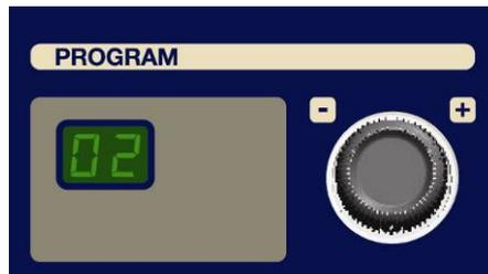
Utilizzando la sezione PROGRAM è possibile memorizzare 16 diverse modalità operative e livelli di potenza.
