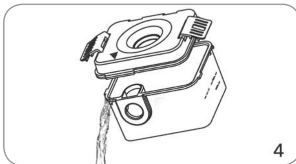
4. Aprire la copertura superiore del contenitore dell'umidificatore e svuotarlo del rimanente contenuto.
