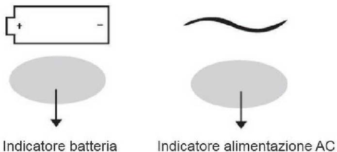
Se le batterie non sono installate, l'indicatore "batteria" rimane spento. Se le batterie sono inserite ed il dispositivo è acceso, il dispositivo fornisce alimentazione alle batterie. Quando il dispositivo è in funzione utilizzando le batterie, l'indicatore "batteria" si illumina di rosso. In caso di batterie in esaurimento, il dispositivo emette tre suoni continui di allarme. In questo caso, spegnere il dispositivo e connettere l'alimentatore AC prima di riaccendere lo strumento.
